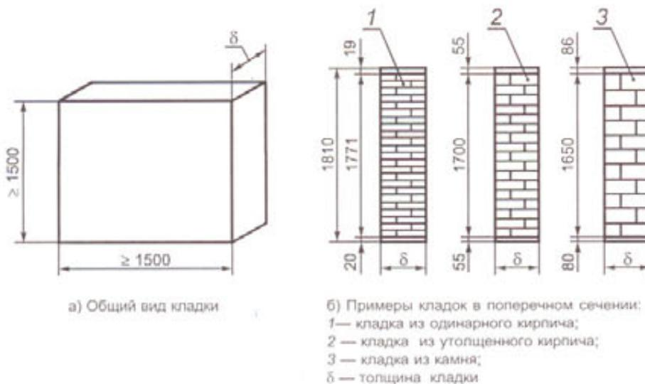
Рисунок 2 — Фрагмент кладки для определения теплопроводности
