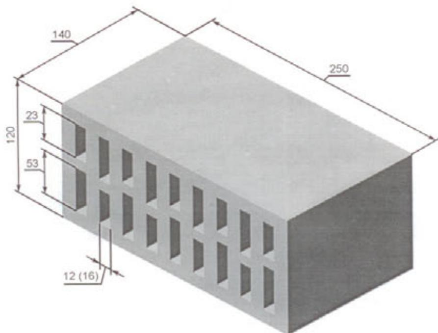
Рисунок А.1.15 — Камень формата 2,1 НФ с 18 щелевидными пустотами
